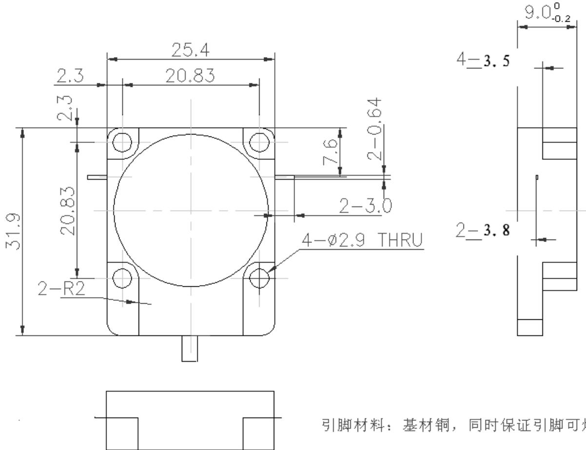
引脚材料：基材铜，同时保证引脚可焊性
