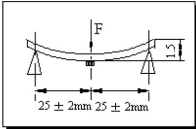
将产品按图焊在  $1.6 \pm 0.2\text{mm}$  的 PCB 板中间，由箭头方向施力： $1\text{mm/S}$ ，弯曲距离： $1.5\text{mm}$ ，保持  $5 \pm 1\text{S}$ ，产品金属层无脱落。
